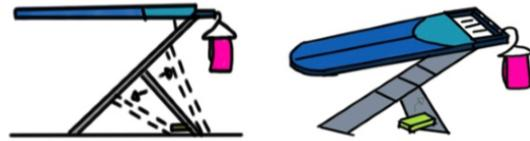
Las patas de la mesa constan de dos diagonales que se pueden doblar para su fácil transportación, otro aditamento en las patas de la mesa es un reposapiés que sirve como soporte para la estabilidad de las personas.
